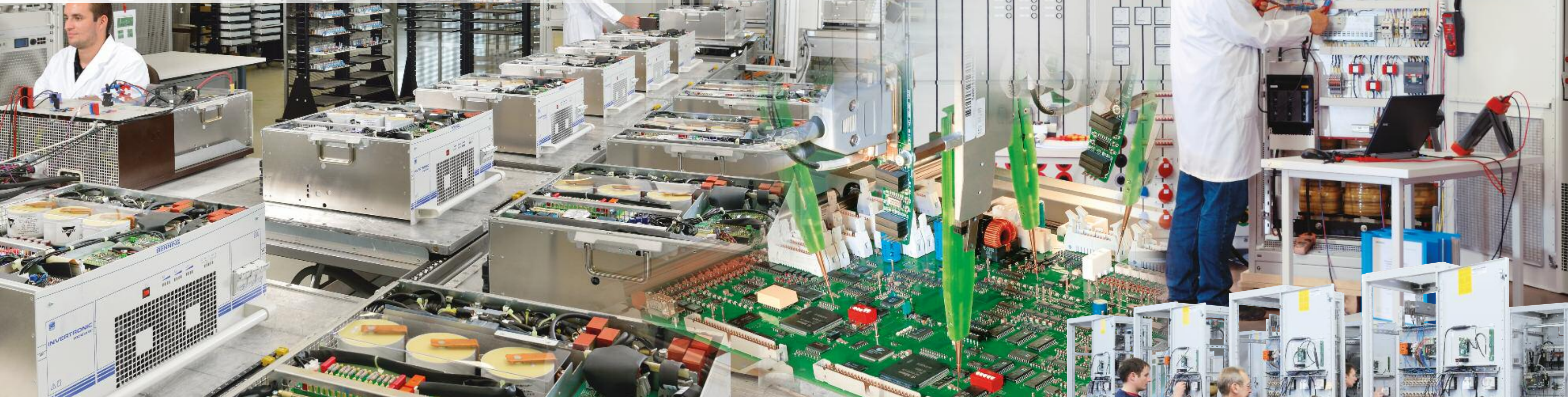
Montage und Prüffeld von Wechselrichtereinschüben Inverter module assembly and test facility
